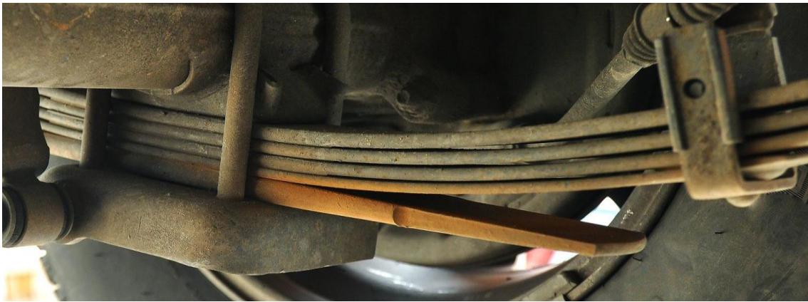
Imagen Núm. 16. de suspensión con Muelles tipo peine
