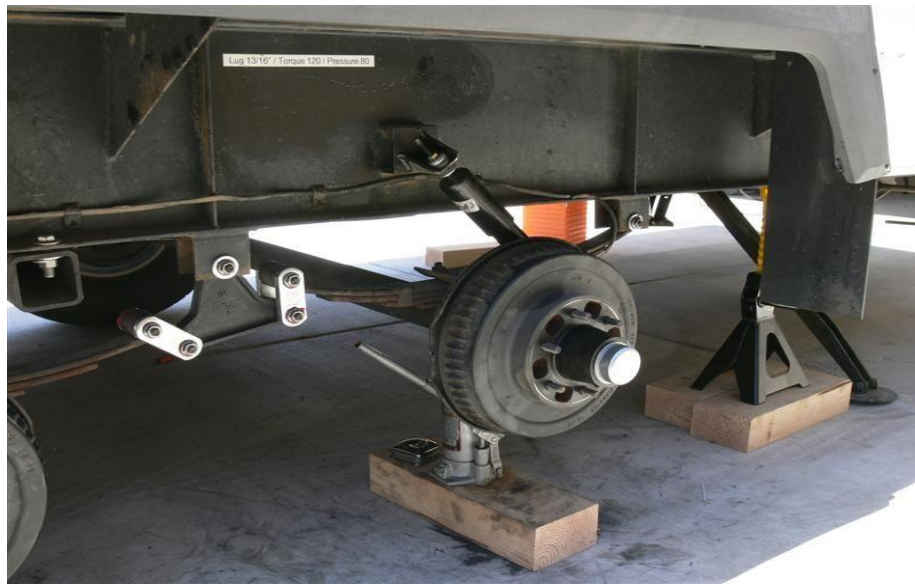
Imagen Num.14, colocación de monas en punto de seguridad (chasis del camión)
