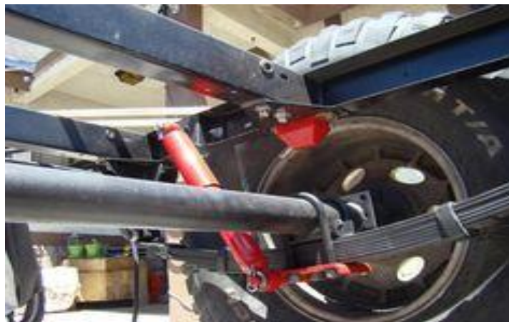
Imagen Núm. 16. de suspensión con Muelles tipo peine
