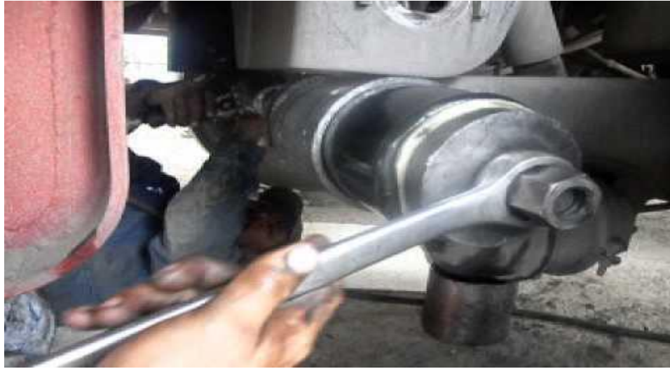
Imagen Num.19, tornillo para colocar bujes de suspensión trasera de cajas de tráiler
